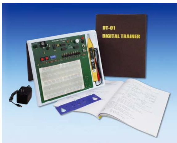
DT-01 Лабораторный набор для сборки цифровых цепей
