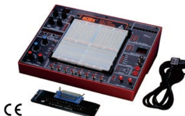
ETS-7000A Цифровая-аналоговая учебная лабораторная система
